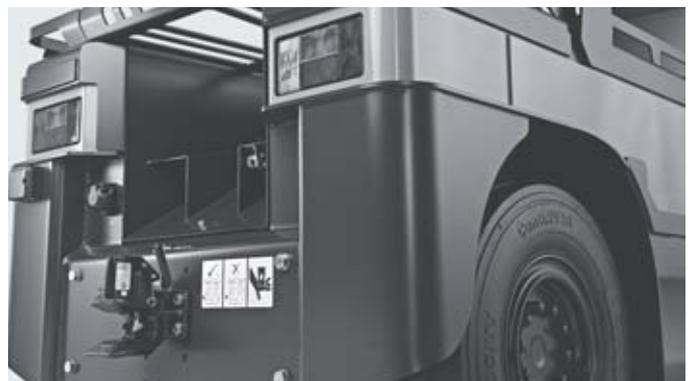
Elektro-Schlepper R 07: Anhängerkupplung zum Einsatz als Schleppfahrzeug
