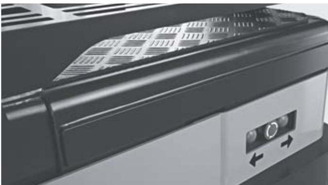
Rücktasteinrichtung zum sicheren Heranfahren an Anhänger
