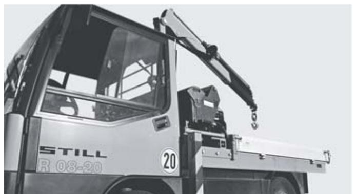
Optionaler, aufgesetzter Kran zum Heben von schweren Lasten
