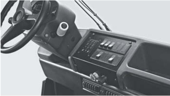
Elektrische Parkbremse und übersichtliches Armaturenbrett mit Ablagefächern für Dokumente und Arbeitsmaterialien
