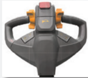
Bedienung der Deichsel (serienmäßig) mit rechts oder links
