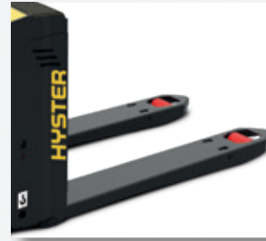
Einfahrrolle für einfachen Betrieb
