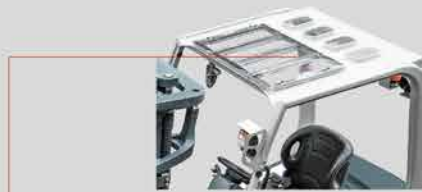
Gestanztes integriertes Fahrerschutzdach mit transparenter Regenschutzabdeckung gewährleistet den Betrieb an Regentagen.
