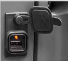
Der Heckgriff und die Warnhupe sind für einen sichereren Rückwärtsbetrieb ausgelegt.
