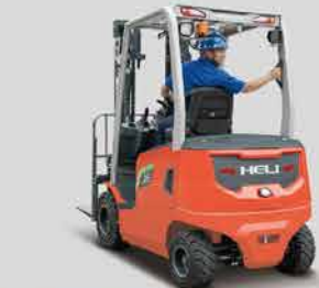
Der Heckgriff und die Warnhupe sind für einen sichereren Rückwärtsbetrieb ausgelegt.
