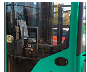
2-Wege-Sprechanlage für Kühlhauskabine (CSM)
