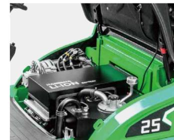
Die Haube (mit einer selbstsichernden Gasfeder) lässt sich weit öffnen und erleichtert die Wartung durch gute Erreichbarkeit aller Komponenten.
