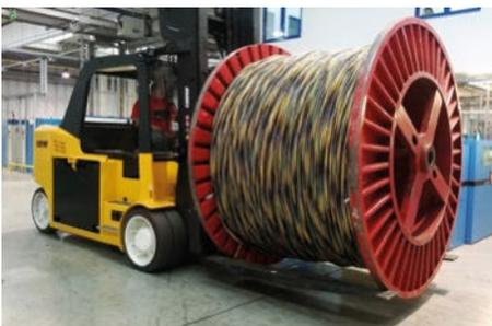
Durch seine sehr kompakte und robuste Bauweise und die Cushionbereifung ist dieser Stapler, mit einer maximalen Tragfähigkeit von 16.000 kg, ideal zum innerbetrieblichen Transport von schweren Gütern in beengten Räumen. Die zwischen den Achsen platzierten Batterien verleihen ihm einen extrem niedrigen Schwerpunkt, um maximale Stabilität zu gewährleisten. Die seitliche Batterieentnahme ermöglicht einen schnellen und sicheren
