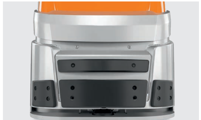
Höchste Sicherheit in Serie: Die Personenschutzanlage (PSA) leitet in einer potenziellen Gefahrensituation den Not-Stopp ein
