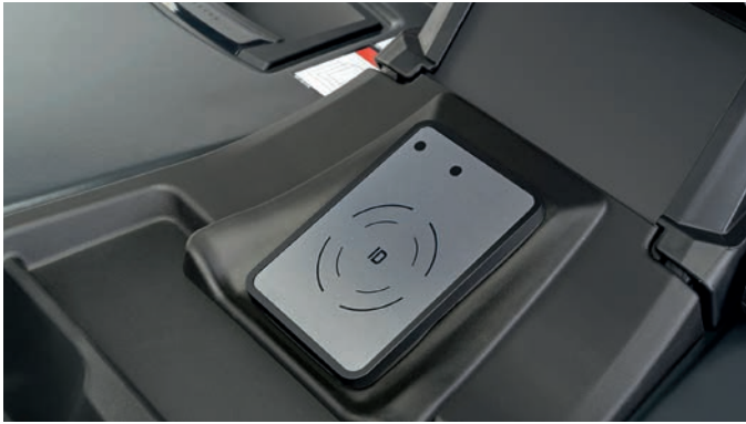
Vielfältige Zugangskontrollmöglichkeiten: Optionaler Zugang mittels FleetManager oder PIN-Code sowie serienmäßiger Zugang über Schlüsselschalter
