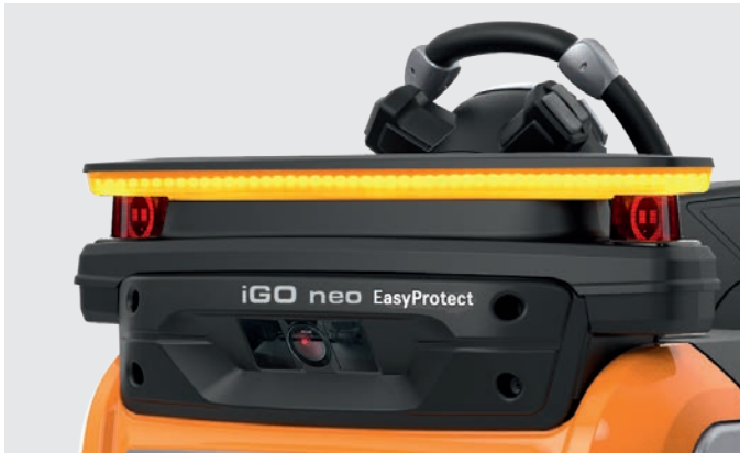
Sicherheit in einer neuen Dimension: Die optionale 3D-Frontkamera des OPX iGo neo erkennt Hindernisse über die gesamte Fahrzeughöhe
