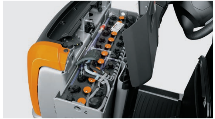
Optionaler, seitlicher Batteriewechsel garantiert höchste Verfügbarkeit und beste Ergonomie für den Anwender
