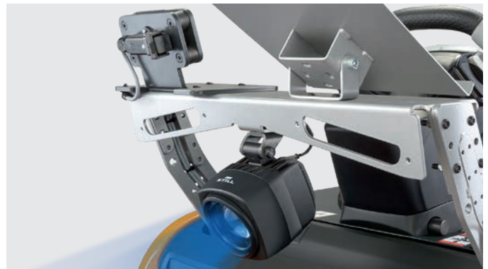
Optionales STILL Safety Light für eine bessere Wahrnehmung des Fahrzeugs und höhere Sicherheit
