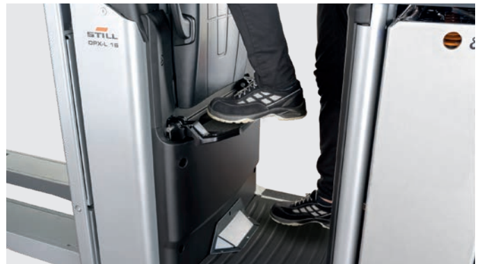
Optionale, klappbare Trittstufe für sporadisches Kommissionieren in der ersten Ebene
