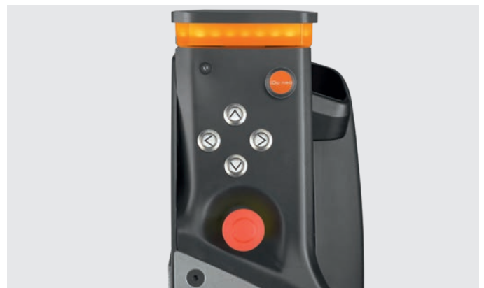
Intuitive Bedienung: Alternativ zur Fernbedingung können die wichtigsten Funktionen über die seitlichen Tastenfelder bedient werden
