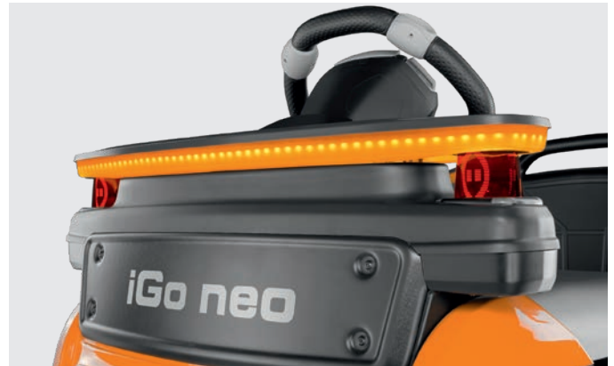
Immer gut informiert: Die LED-Signaleinheiten informieren den Bediener über den aktuellen Betriebsmodus des Fahrzeugs
