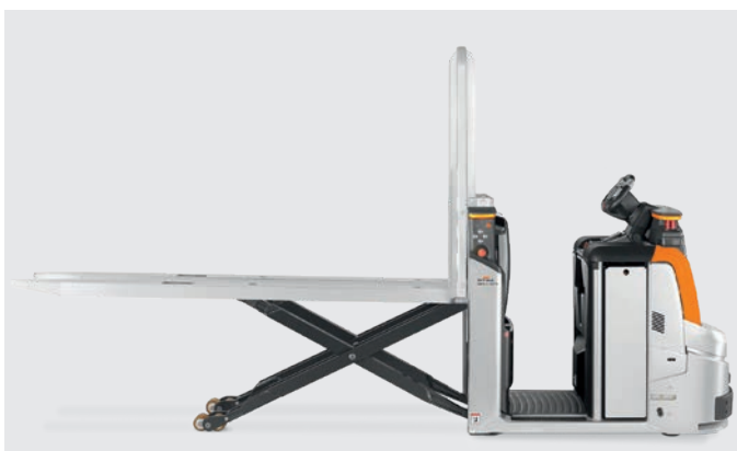
Das richtige Niveau: Frei wählbare Hubhöhen bei der Fahrzeugvariante OPX-L 20 S iGo neo für zusätzliche Ergonomie
